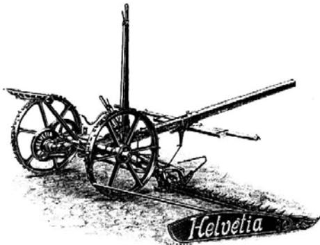
Mähmaschine für Zugtiere. Sie besteht aus Fahrgestell, Getriebe und Schneidapparat. Die Kraftübertragung erfolgt über die Fahrräder. Verschiedene Ausführungen für Ein- und Zweispannerzug, Pferde- oder Viehbespannung.
